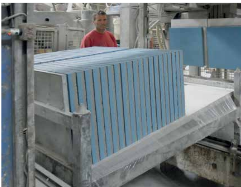
Impianto di movimentazione automatica del prodotto. Automatic handling system of Terrazzo Tiles.
