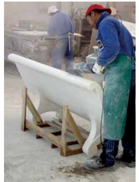
Levigatura di una panchina in graniglia di marmo. Polishing phase of a concrete bench.
